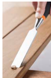
Kapning med ett skarpt stämjärn
